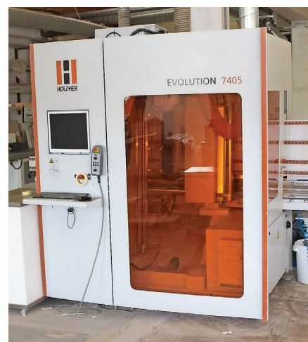
Das vertikale Bearbeitungszentrum Evolution 7405 für große und kleine Teile
