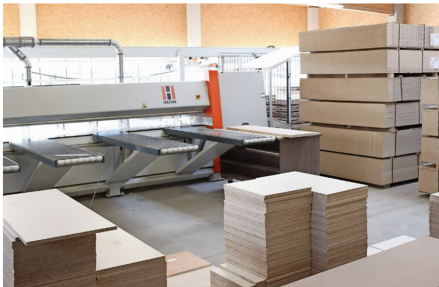
Platten werden „chaotisch“ oder sortenrein eingelagert und „wandern“ per Vakuumgreifer rasant schnell zum Zuschnitt zur Plattensäge Zentrex 6220.
