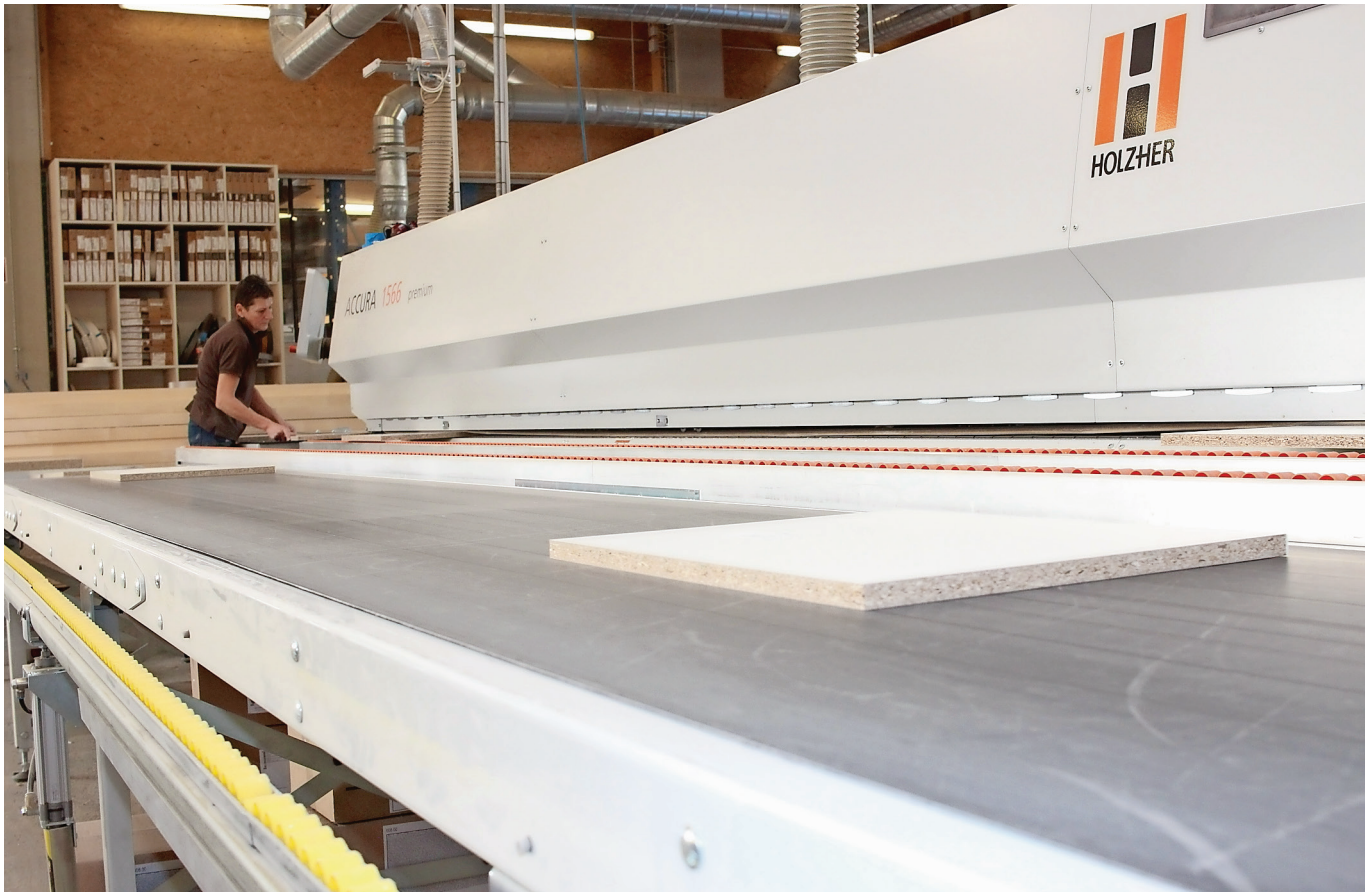
Die Kantenleimmaschine Accura 1566 industry sorgt mitsamt dem Leimauftragungssystem Glue Jet in der Fertigung bei Zottler für die gewünschte Kantenqualität.
