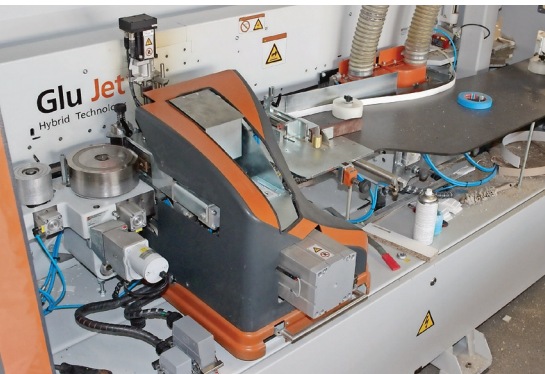
Beim Glue Jet-System wird dünnflüssiger PUR-Kleber über eine spezielle Auftragsdüse unter hohem Druck in die Plattenporen injiziert.
