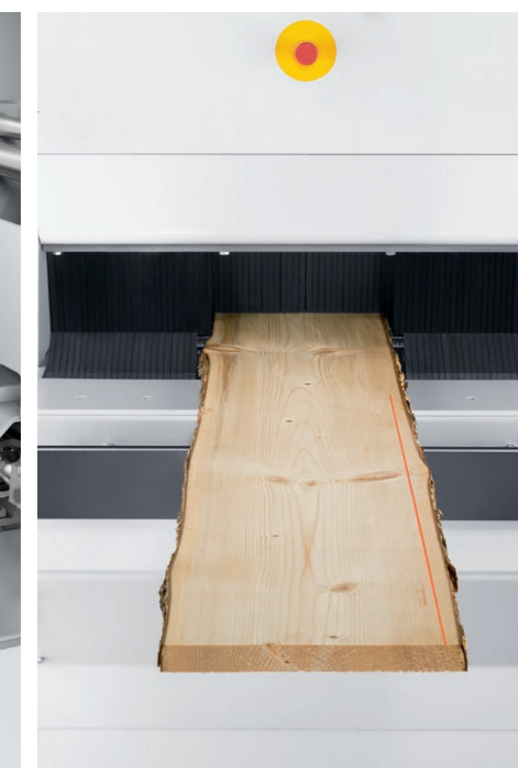
Laser do wskazywania linii cięcia: Widzimy, co jest cięte.
