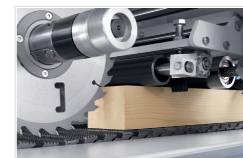
Wysokość cięcia do 110 mm
