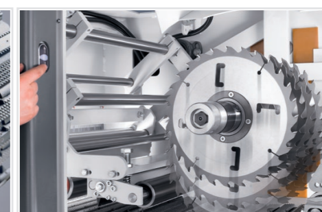
Elektryczna regulacja wysokości wału piłowego: wysoki komfort obsługi
